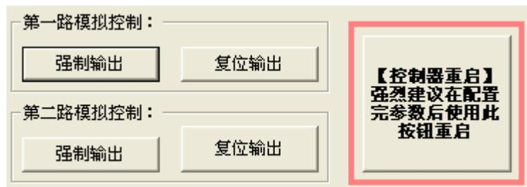
对于只有普通开关输出的控制器， 可以使用此处的按钮做打开输出， 关闭输出操作， 点击
