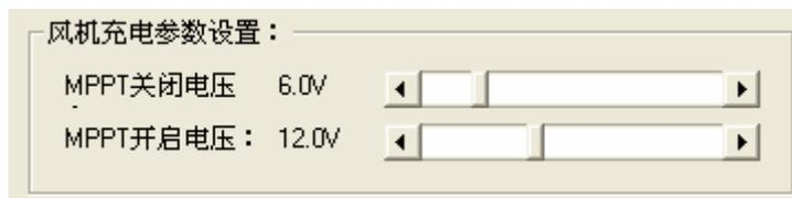
**MPPT 开启电压:** 当风机输入电压大于此参数电压后,MPPT 算法开始运行,控制器自动对风机输入实行最大功率跟踪输入,提高风机发电效率。
